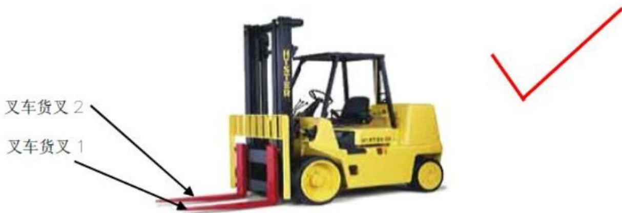
图 7-2 叉车货叉插入底座示意图
